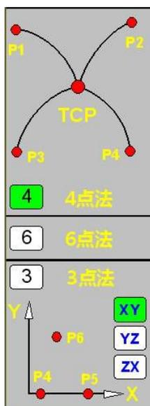
针对客户对安装工具的姿态进行校正的需求，我们独立提供了一种“三点法”模式来方便客户对工具姿态进行校准。“三点法”相当于六点法中的最后三个点（第四点、第五点、第六点）。这种方法只修正工具的姿态，不改变工具的TCP位置点。
