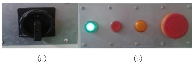
图7.1 电控柜面板
