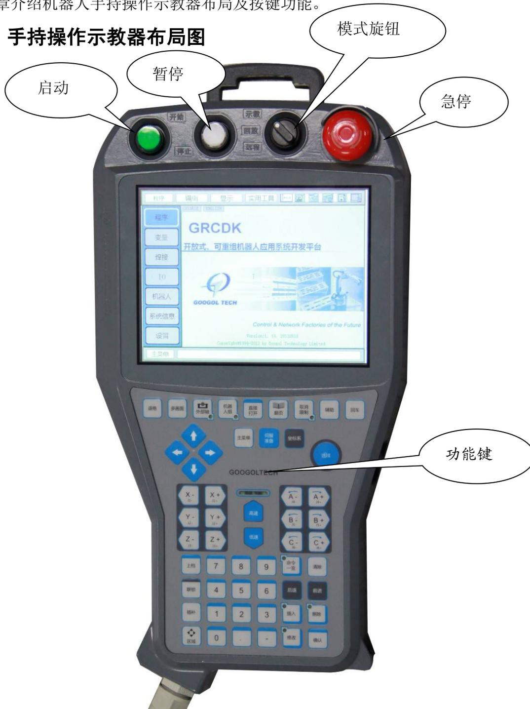
图 5.1 手持操作示教器布局图
